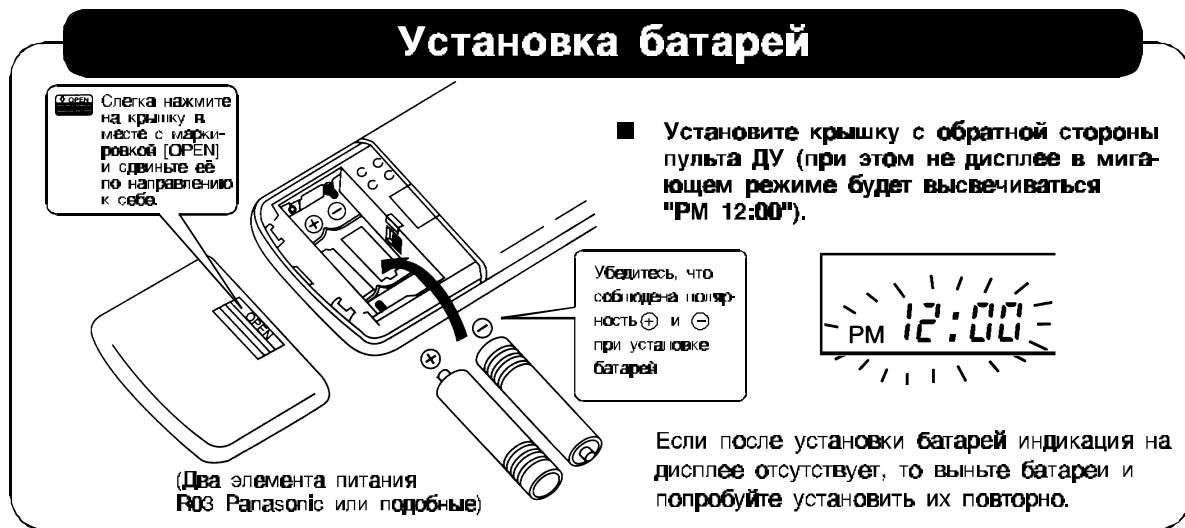
Если после установки батарей индикация на дисплее отсутствует, то выньте батареи и попробуйте установить их повторно.
