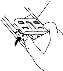
Кнопка выключения таймера
