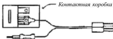
3. Соединительный кабель RAC между модулем QSS-Checker и наружным блоком серии RAC
