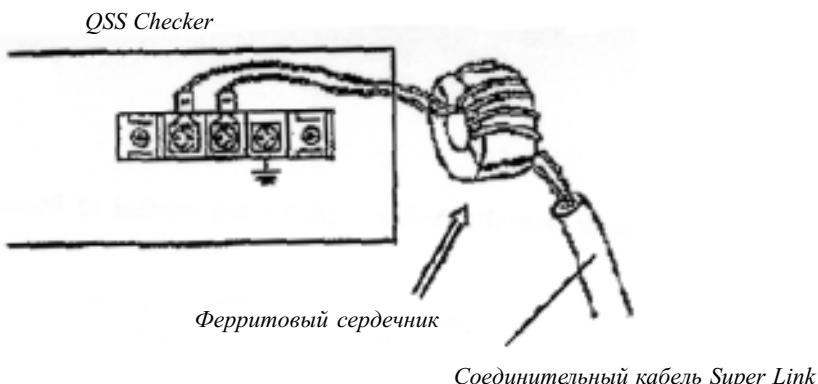
**1.1.4.** Включите компьютер и модуль QSS-Checker. Установите переключатель 2 модуля (On site/Remote) Локального/Дистанционного мониторинга в положение On site. Установление надлежащего соединения индицируется высвечиванием светоиндикатора 11 модуля. Программу мониторинга можно запускать.
