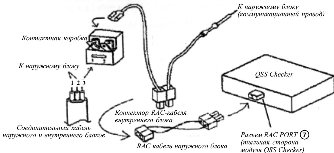
**Примечание:** В случае использования мульти-сплит системы подключите каждый соединительный кабель между внутренним и наружным блоками к модулю QSS-Checker.
