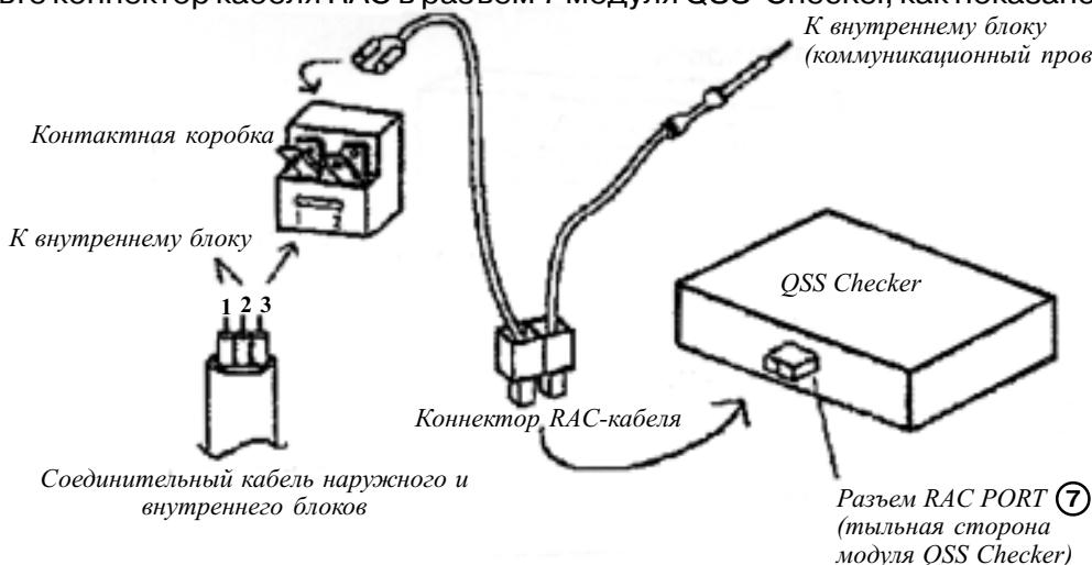
**Примечание:** В случае использования мульти-сплит системы подключите каждый соединительный кабель между внутренним и наружным блоками к модулю QSS-Checker.
