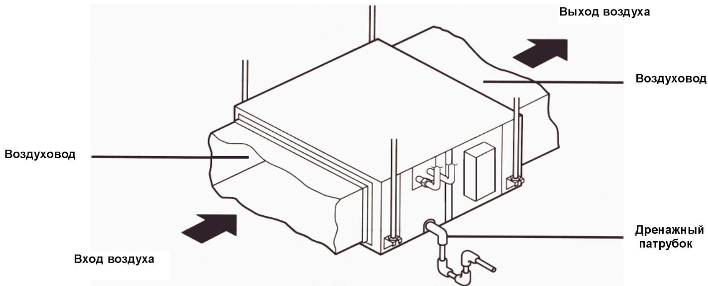
Примечание: Внутренний блок устанавливается внутри потолка, и т.д., таким образом, холодный (тёплый) воздух проходит через воздуховод.
