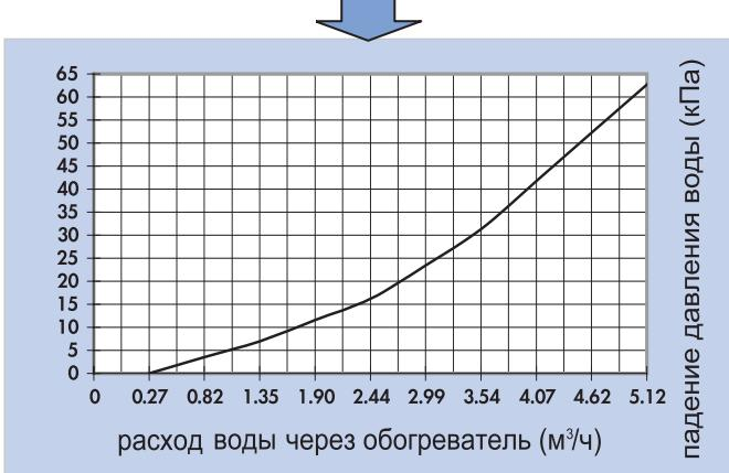
**2.** По диаграмме выбираем расход воздуха при конкретной температуре входящего воздуха. Далее проводим прямую линию до пересечения с известным нам температурным перепадом воды и находим теплопроизводительность обогревателя, далее проводим прямую линию до пересечения с диаграммой расхода воды и находим расход воды через обогреватель и падение давления воды.
