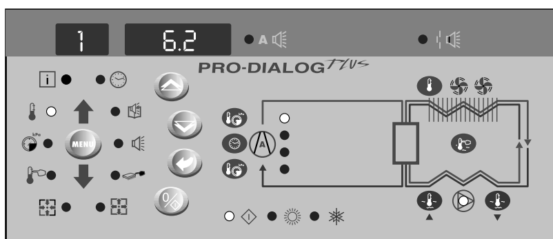
Панель управления контроллера PRO-DIALOG Plus
