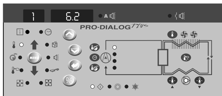
Лицевая панель контроллера PRO-DIALOG Plus
