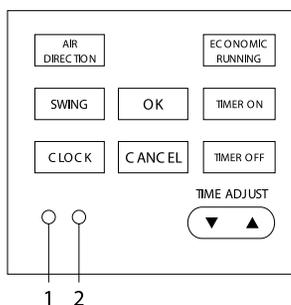
1. При нажатии кнопки LOCK (БЛОКИРОВКА) все текущие настройки и кнопки пульта ДУ блокируются. Пользуйтесь кнопкой LOCK для предотвращения случайного изменения настроек кондиционера. Для отмены функции блокировки повторно нажмите кнопку LOCK.
