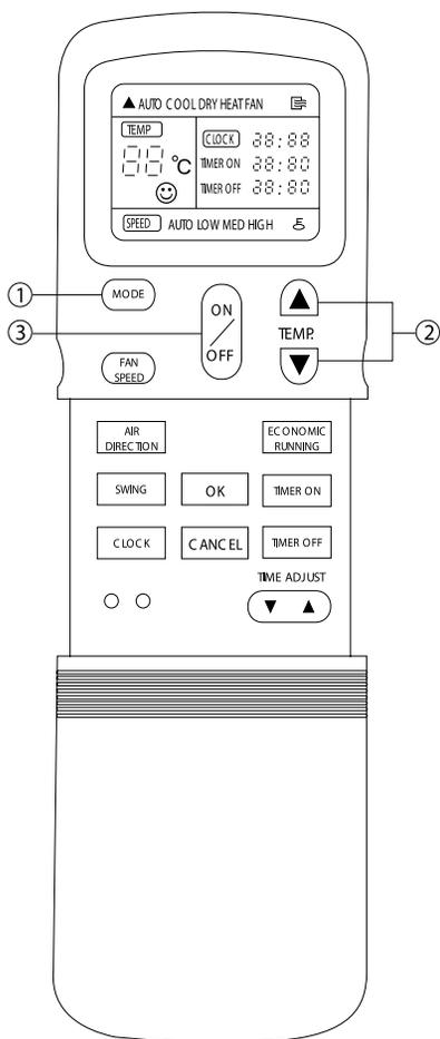
В автоматическом режиме работы микропроцессор автоматически выбирает режим ОХЛАЖДЕНИЯ, ОБОГРЕВА (для моделей с режимом обогрева) или ВЕНТИЛЯЦИИ по разности между заданной и фактической температурой воздуха в помещении.
